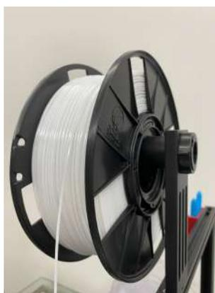
**Figura 12 - Carretel de 1kg de PETG sendo utilizado para impressão.**
