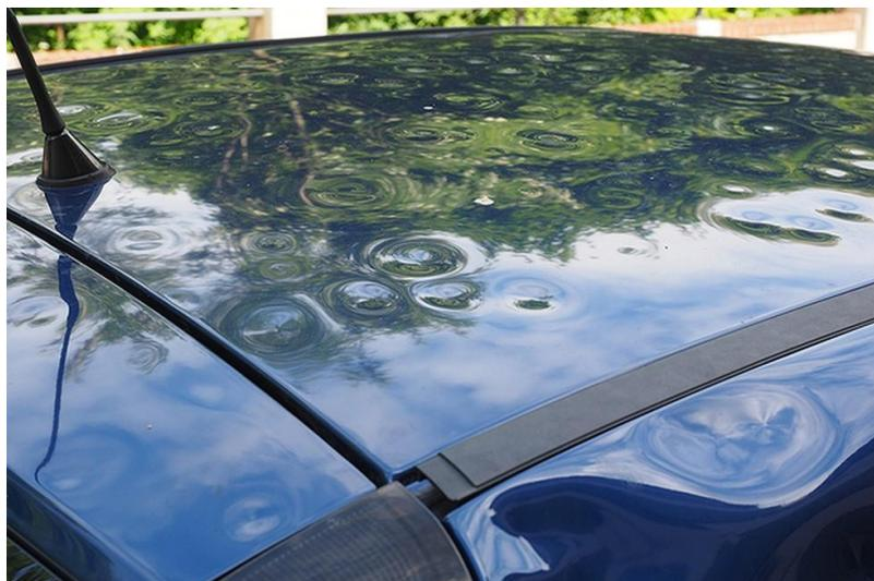
**Figura 57 - Deformação em automóvel causada por chuva de granizo**
