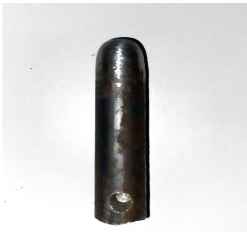
**Figura 27 - Ferramenta indentadora**
