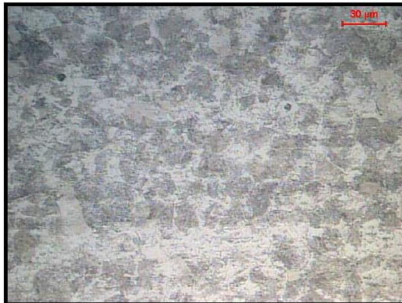
**Figura 5.** Análise microestrutural via MO do aço 4340. (Fonte: [19])
